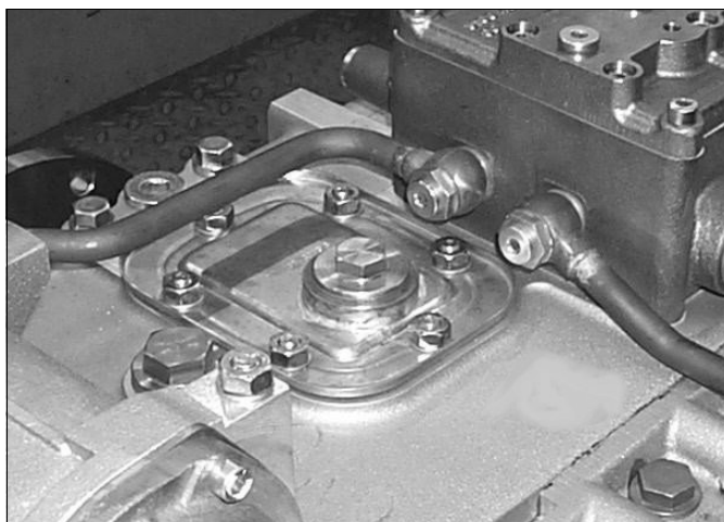
Fig. 83: Coperchio dell'apertura d'ispezione – vista dall'alto (esempio)
