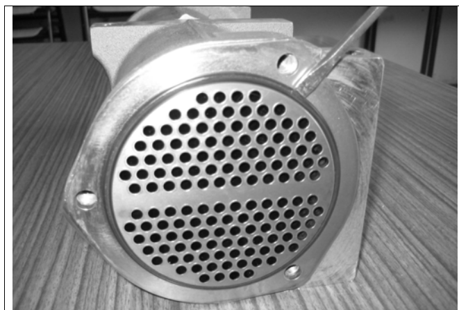
Fig. 96: Smontaggio degli O-ring (esempio)
