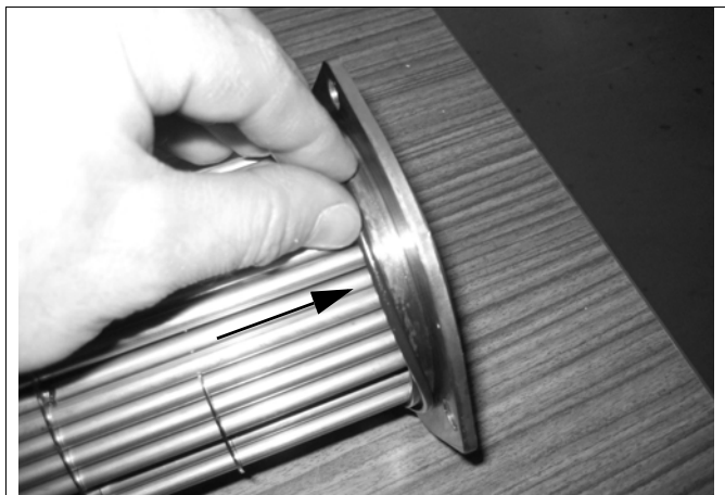
Fig. 105: Montaggio O-ring lato acqua (esempio)
