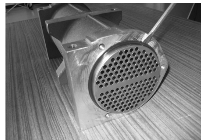
Fig. 101: Smontaggio dell'O-ring sul lato opposto al lato acqua (esempio)
