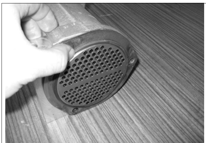
Fig. 104: Montaggio degli O-ring esterni (esempio)
