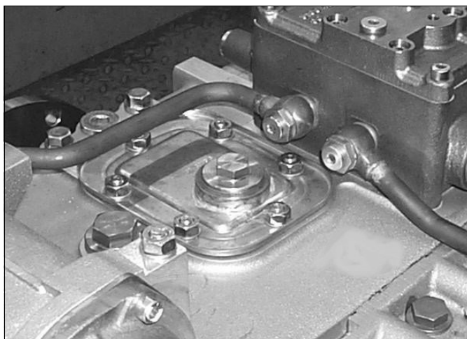
Fig. 80: Coperchio dell'apertura d'ispezione – vista dall'alto (esempio)
