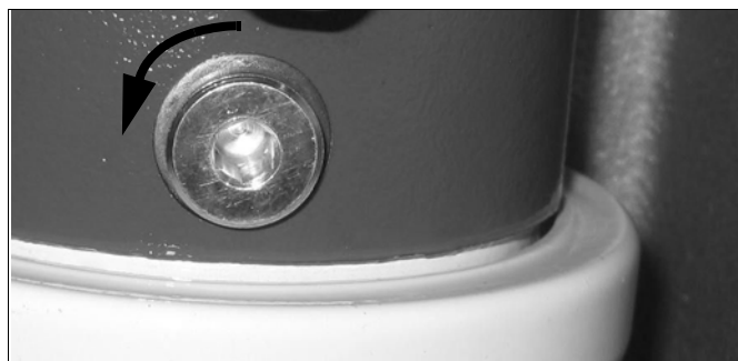
Fig. 52: Vite di sfiato del filtro dell'olio (esempio)
