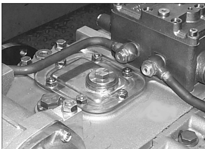
Fig. 82: Coperchio dell'apertura d'ispezione – vista dall'alto (esempio)
