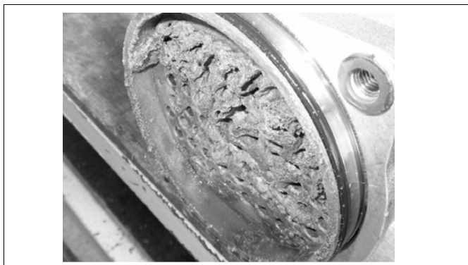
Fig. 31: Fouling: depositi organici sul fascio tubiero causati da bassa velocità di flusso e da inattività prolungata (esempio)
