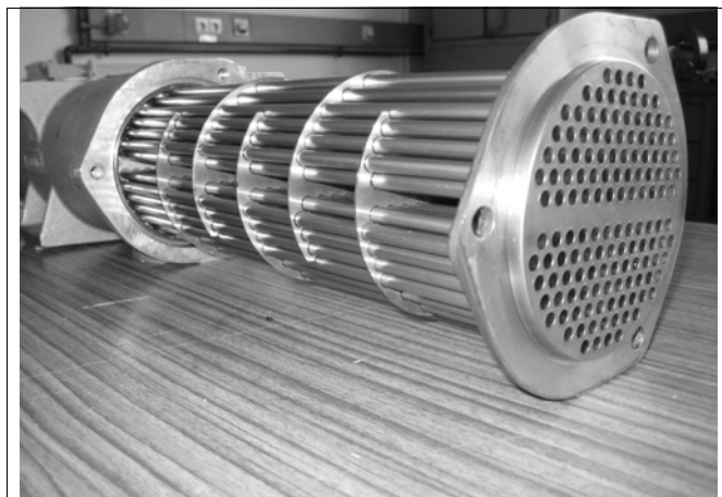
Fig. 102: Smontaggio del fascio tubiero (esempio)
