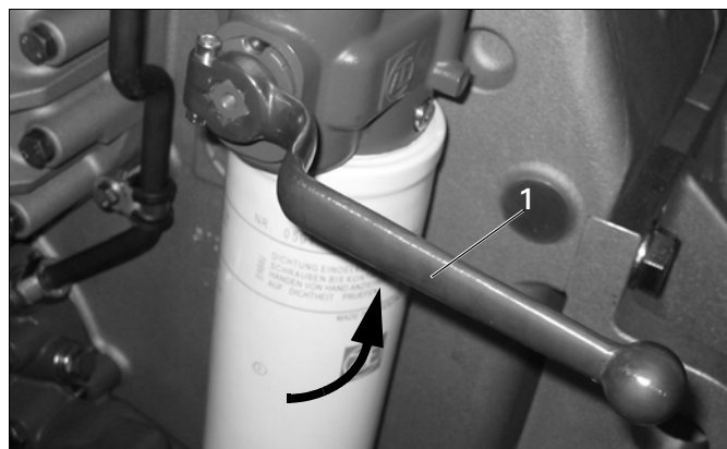
Fig. 76: Leva di inversione in posizione ore tre (esempio)
