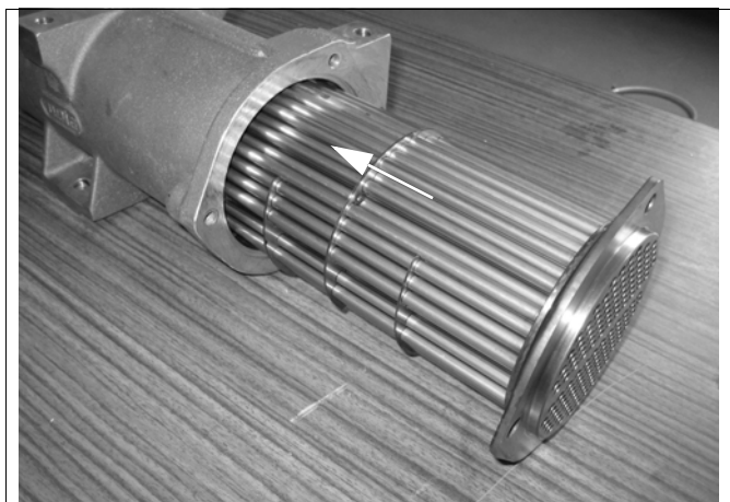
Fig. 106: Montaggio del fascio tubiero (esempio)
