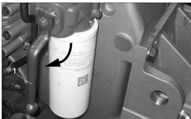
Fig. 77: Leva di inversione in posizione ore sei (esempio)
