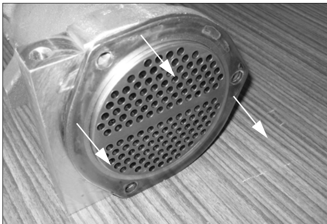
Fig. 100: Togliere la lamiera distanziale (esempio)
