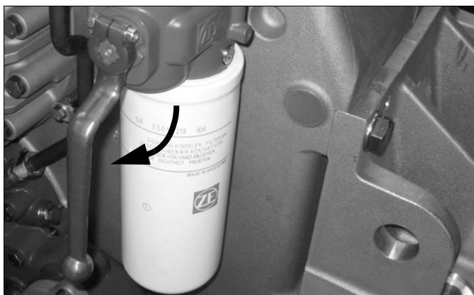
Fig. 54: Leva di inversione in posizione ore sei (esempio)
