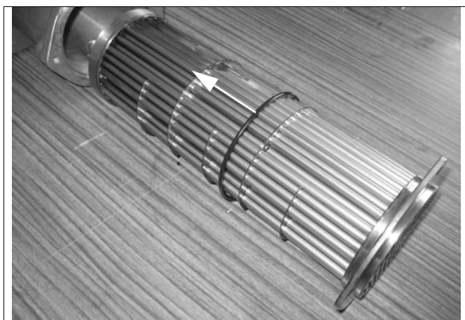
Fig. 103: Rimuovere O-ring lato acqua (esempio)
