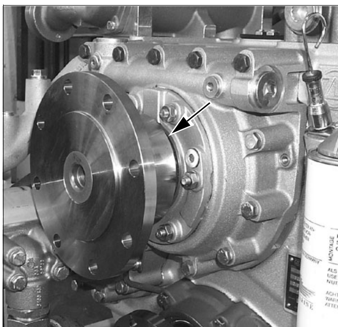
Fig. 111: Anello di tenuta dell'albero d'entrata ZF 2150 V (esempio)
