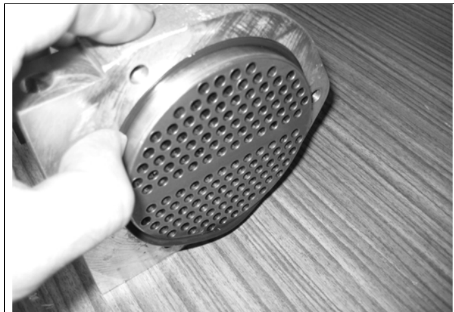
Fig. 107: Montaggio O-ring lato opposto al lato acqua (esempio)
