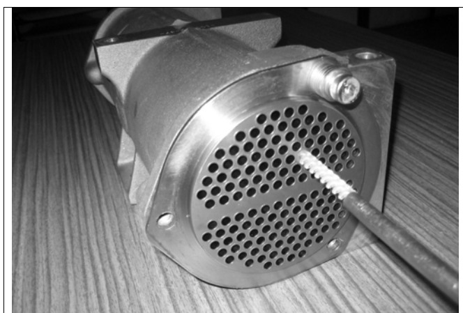
Fig. 98: Pulizia dei tubi con una spazzola di nylon (esempio)
