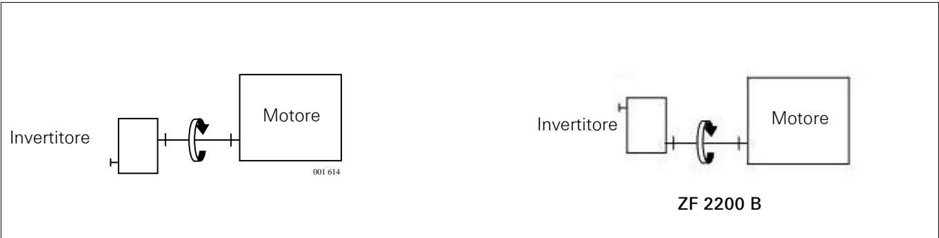
Fig. 12: Senso di rotazione, invertitore albero d'entrata (versione standard)
