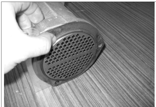
Fig. 109: Montaggio degli O-ring esterni (esempio)
