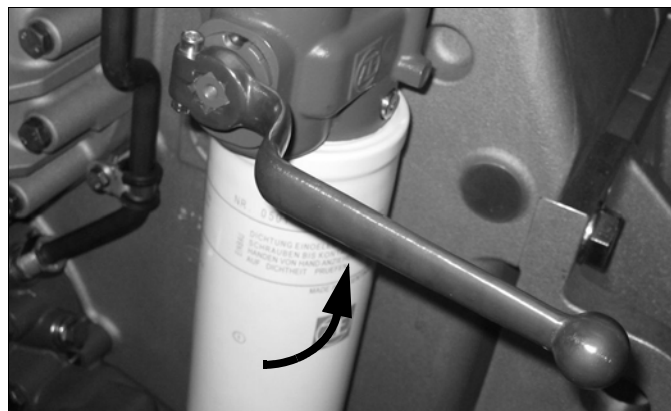
Fig. 51: Leva di inversione in posizione ore tre (esempio)
