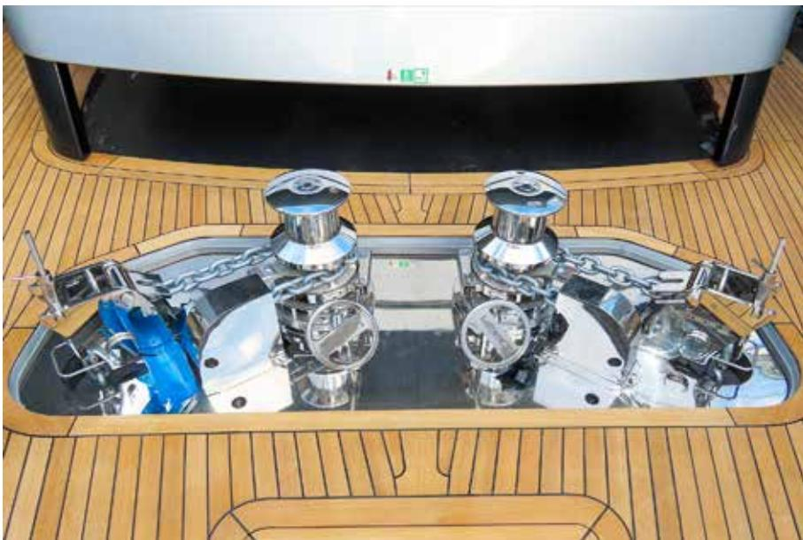
L'imbarcazione è dotata di due verricelli salpa ancora che movimentano le ancore alloggiate a prua.
