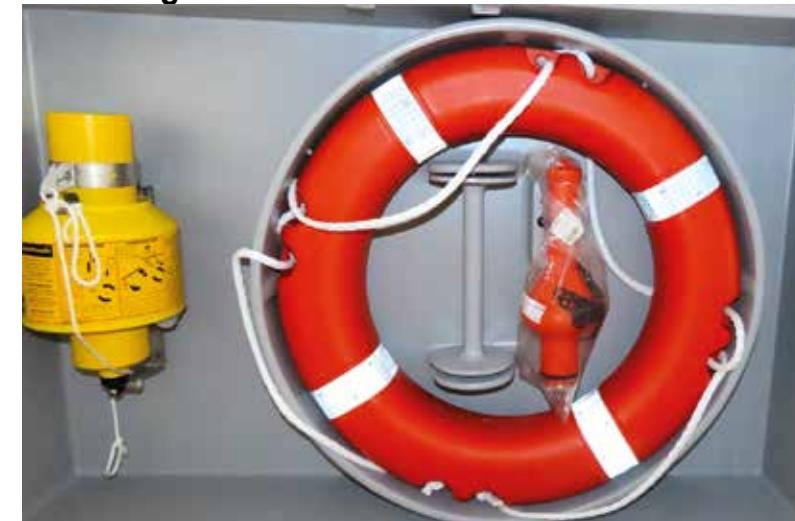
Il salvagente anulare è dotato di una cima lunga 30 metri e di una boetta luminosa ad attivazione automatica. La cima in dotazione è di tipo non attorcigliabile e di colore arancione per essere più visibile in acqua.
